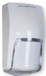
Rivelatore infrarosso volumetrico per interni, radio bidirezionale. Doppia banda di frequenza 433/868MHz. Protocollo radio di comunicazione Tecnoalarm della serie 500 (SYNC@BWL). Disponibile in quattro versioni con diagramma di copertura e portata differenziati, per le protezioni: volumetrica, lungo raggio, tenda, volumetrica animali. Autoprotetto da apertura e rimozione. Batteria di alimentazione al litio in dotazione. Contenitore ABS. Colore bianco.
